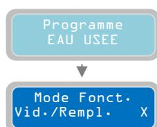
Le paramètre "mode de fonctionnement vidange / Remplissage" va définir le mode du programme "EAU USEE" à "vidange" ou "remplissage". Avec "vidange" les interrupteur à flotteur de démarrage / arrêt des pompes sont à l'intérieur du réservoir dans lequel la pompe est installée. Avec "remplissage" les interrupteurs à flotteur de démarrage / arrêt sont dans un réservoir différent duquel les pompes sont installées.
