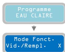
Le paramètre "mode de fonctionnement Vidange / Remplissage" définit le mode du programme "EAU CLAIRE" à "vidange" ou "remplissage". Typiquement avec le mode "vidange" les interrupteurs à flotteur ou de pression de démarrage /arrêt des pompes sont à l'intérieur du réservoir dans lequel la pompe est installée. Avec le mode "remplissage" les interrupteurs à flotteur ou de pression de démarrage /arrêt sont dans un réservoir différent de celui des pompes.
