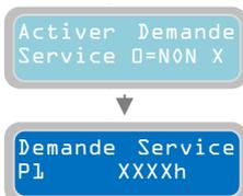
Le paramètre "Demande de Service P1" fixera le nombre maximal d'heures de fonctionnement pour la pompe1 avant que l'alarme de demande de service serait activée. L'alarme sera affichée et il sera possible d'activer une ou plusieurs sorties d'alarme (en fonction du réglage dans le menu "Réglage des alarmes").
