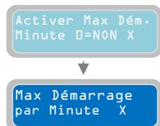
Le paramètre "Max Démarrage par Minute" fixera le nombre maximal de démarrage de la pompe par minute. Si la pompe exécute un certain nombre de démarrages par minute plus élevé que la valeur de consigne il sera arrêté et une alarme sera déclenchée. Le fonctionnement de la pompe sera inhibé jusqu'à la remise à zéro de l'alarme. La réinitialisation de l'alarme se fera automatiquement à l'écoulement de la minute.
