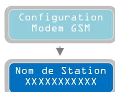
Avec le paramètre vertical "Nom de la station" il est possible de donner un nom au panneau de commande / système. Le nom apparaîtra dans le SMS de réponse chaque fois qu'il y aura un test de connexion GSM (voir paramètres suivants).
