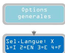
Le paramètre "Selection Langue" donnera le choix de la langue pour les messages d'alarme à afficher (le 'X' indique la position du paramètre à modifier):
