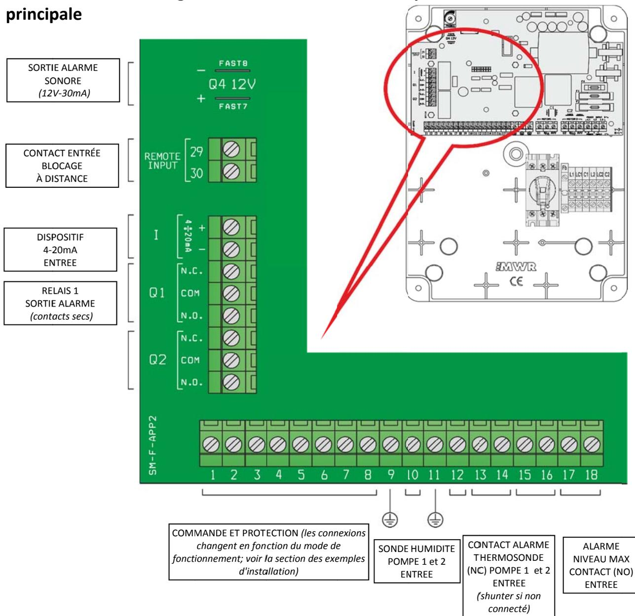
**NB:** Pour un fonctionnement correct des sondes de détection de l'eau dans la chambre d'huile (si installées), assurez-vous que la terre (PE) des pompes est équipotentielle à la terre (PE) du coffret de contrôle.
