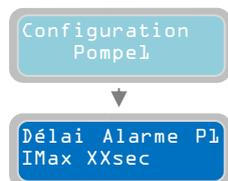
Le paramètre "Délai d'alarme P1 I max" fixera le délai pour l'activation de l'alarme à la consommation de courant maximum (de surintensité): le seuil doit être franchi (sursintensité) pour la quantité de temps spécifiée pour déclencher l'alarme et arrêter la pompe.
