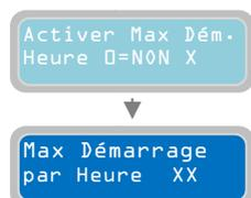
Le paramètre "Max Démarrage par Heure" fixera le nombre maximal de démarrage de la pompe par heure. Si la pompe exécute un certain nombre de démarrages par heure plus élevé que la valeur de consigne il sera arrêté et une alarme sera déclenchée. Le fonctionnement de la pompe sera inhibé jusqu'à la remise à zéro de l'alarme. La réinitialisation de l'alarme se fera automatiquement à l'écoulement de l'heure.
