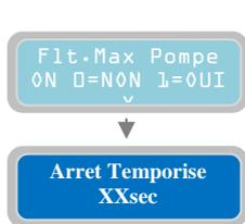
Le paramètre "Arret Temporise" sert à définir un délai pour l'extinction des pompes après l'ouverture du flotteur d'alarme. Ce paramètre concerne uniquement les programmes d'opération CLEAN-DRAINING, DIGIT-DRAINING et MULTITANK (avec le programme DIGIT-DRAINING pour la pompe 1). Il est activé lorsque le paramètre précédent "Gal. Max. Pumps ON ", est réglé sur 1, c'est-à-dire activé.
