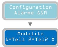
Le paramètre "Modalite" de l'alarme GSM va régler le mode d'envoi des messages SMS d'alarme. Chaque modem GSM installé peut gérer jusqu'à un maximum de 3 numéros de téléphone; Ce paramètre "Mode", fixera les numéros de téléphone qui recevront les SMS d'alarmes.
