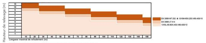
Sélection donnée à titre indicatif pour une tuyauterie de dia. Int de 64 mm et d'un débit d'environ 15 m²/h
