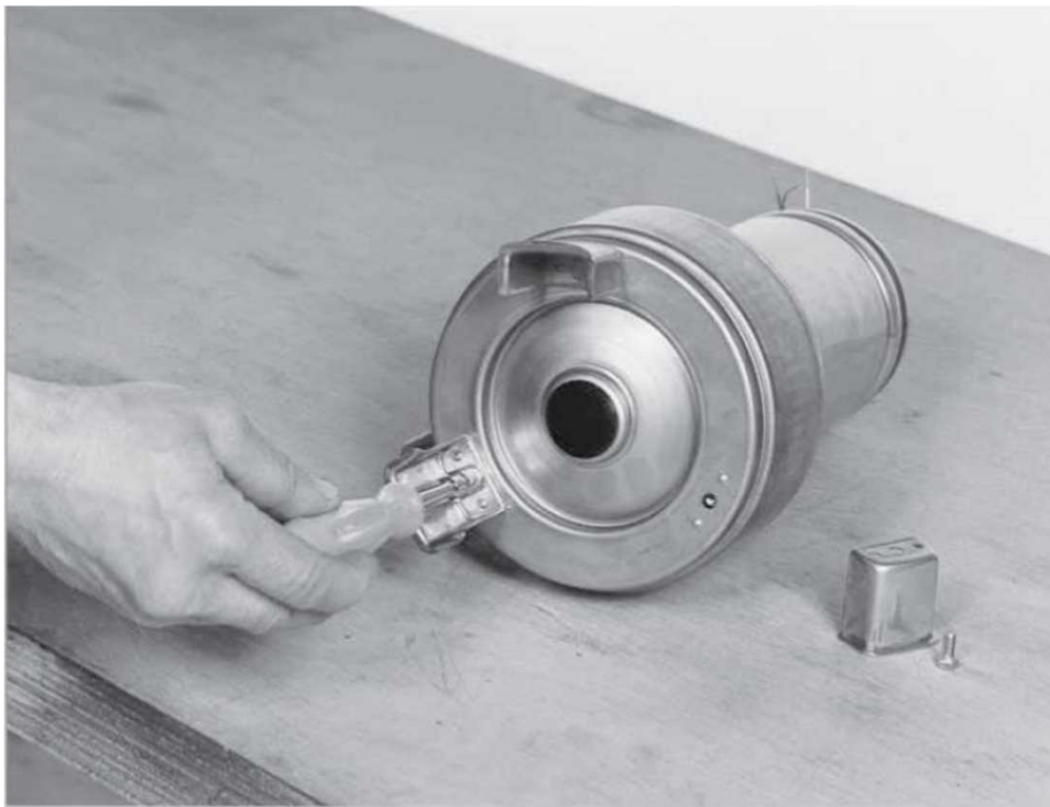
DX(VM)50 : A l'aide d'un tournevis, desserrer les vis qui maintiennent le pied. (Figure 11)
