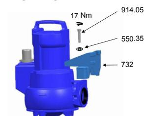
III. 13: Montage de la griffe pour guidage par câble, par 1 barre et par étrier
