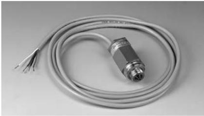
Capteur de détection de présence d'eau basé sur un système opto-électronique, non invasif et sans pièces en mouvement. Le capteur fournit un contact électronique (on/off) à utiliser pour arrêter l'électropompe en cas d'absence d'eau dans la zone de la garniture mécanique.
